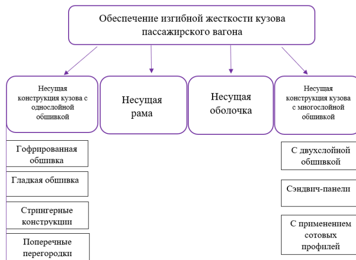
Рисунок 1.1 – Схема обеспечения изгибной жесткости кузова пассажирского вагона
